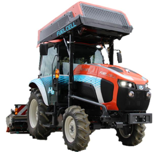
燃料電池トラクタ試作機
