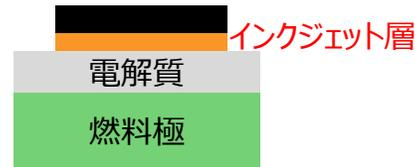
空気極/電解質界面へインクジェット印刷層を形成
