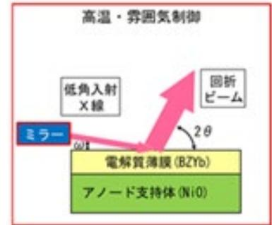
薄膜XRD測定/in-Situ XRD
