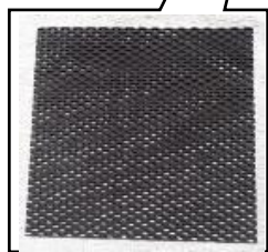
Tiメッシュ上に IrO 2 を塗工した DSE®電極
