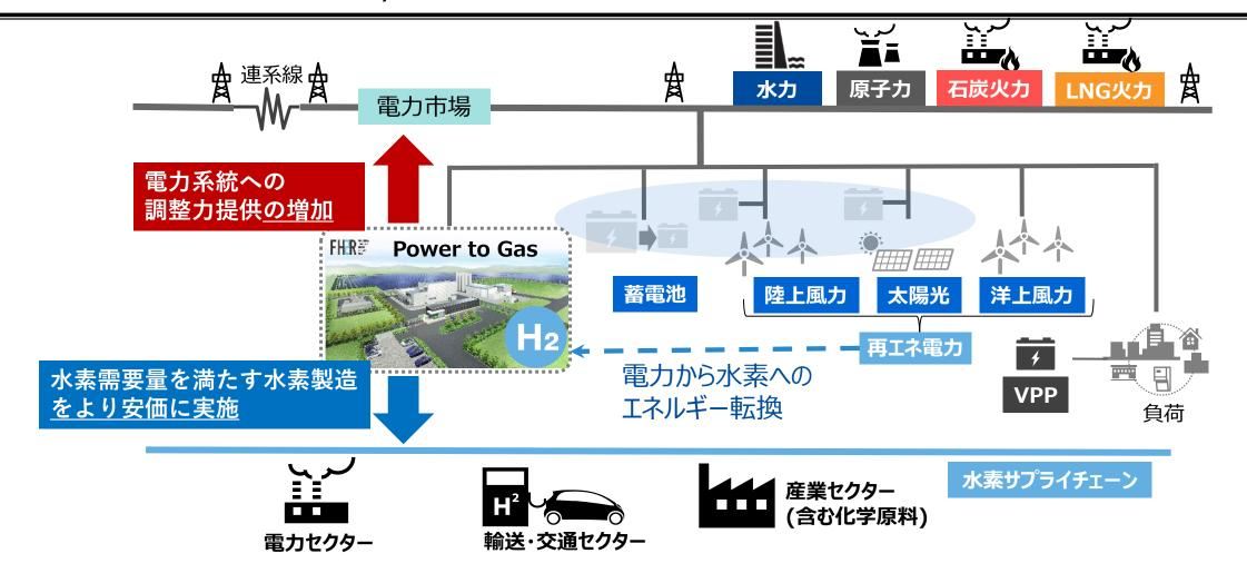
最適稼働条件で無い場合においても、「電力系統への調整力提供の増加」と「水素需要量を満たす水素製造をより安価に実施」の両立を実現する
