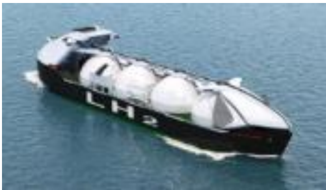
図1 大型液化水素運搬船
