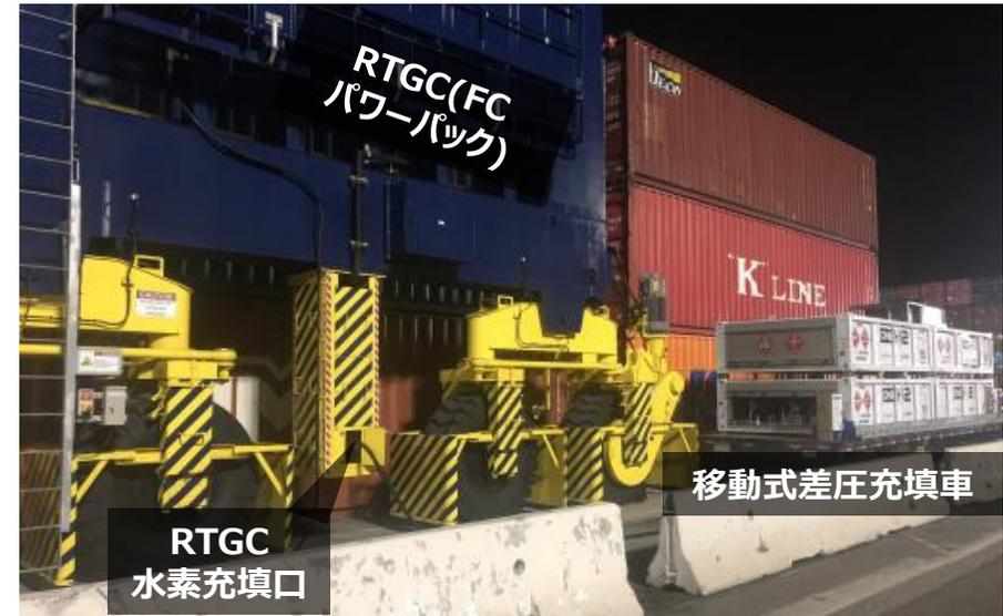
移動式差圧充填車による充填作業
